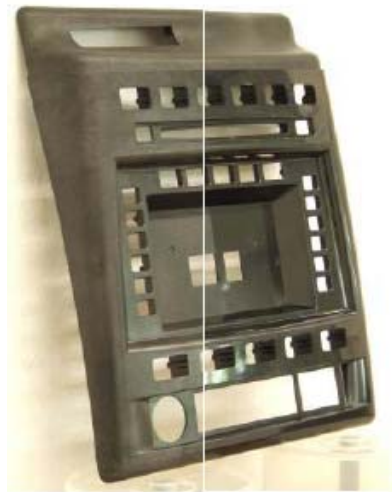
Fig. 12: Comparación estética de una misma pieza hecha por inyección convencional (parte izquierda) o por Heat & Cool (parte derecha).
