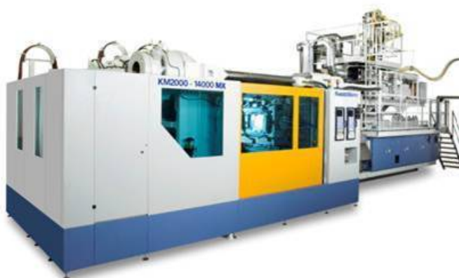
Fig 8: Máquina de inyección compounder de Krauss Maffei
